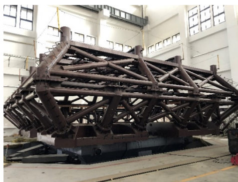
圖 1 南國震天花板系統試驗構架
