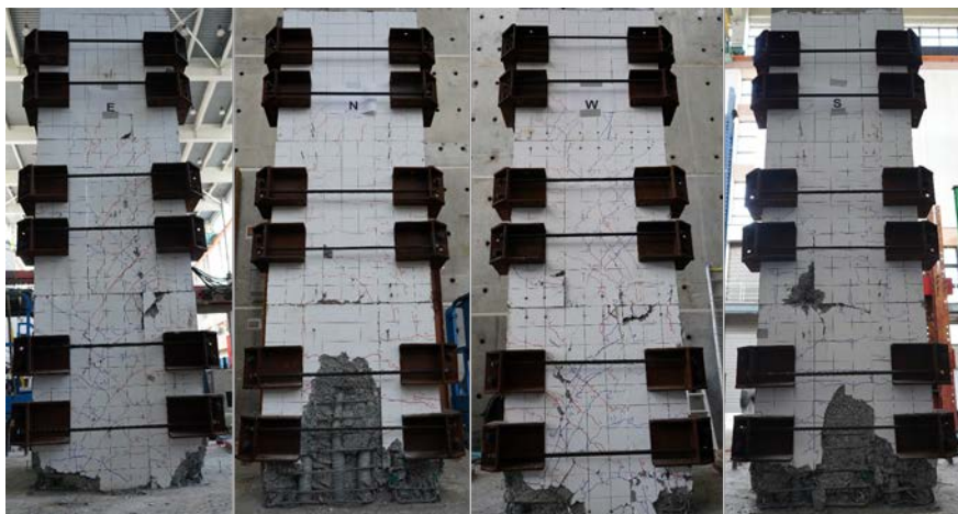
圖 6 外置圍束預鑄節塊橋柱試體最終破壞情況 (8%) 未圍束 有圍束 未圍束 有圍束 未圍束 有圍束
