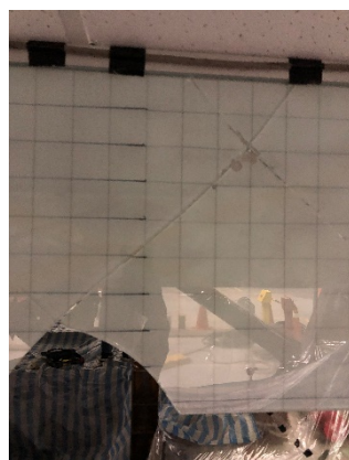
圖 17 B 試體中間玻璃損壞情形
