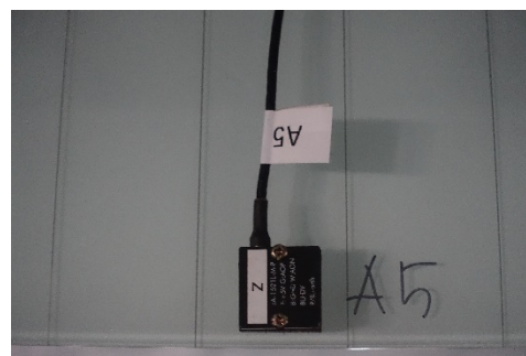
圖 8 安裝於鋼絲網玻璃板片之加速規
