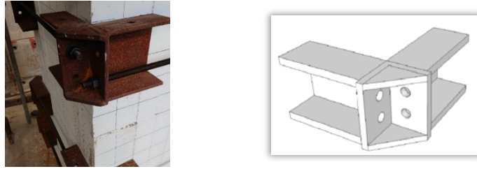
圖 2 模組化預鑄節塊試體外置圍束示意圖
