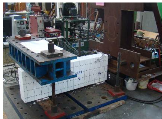
圖 3 握裹試驗之實際試驗裝置圖
